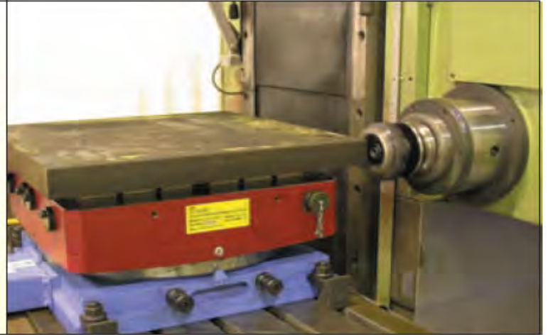
Špeciálny model EEPM platne na obrábanie extra dlhých kusov na frézach a brúskach
