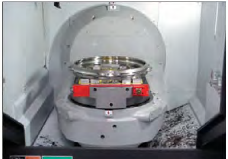
EEPM platňa použitá na 5 osom obrábacom CNC centre
