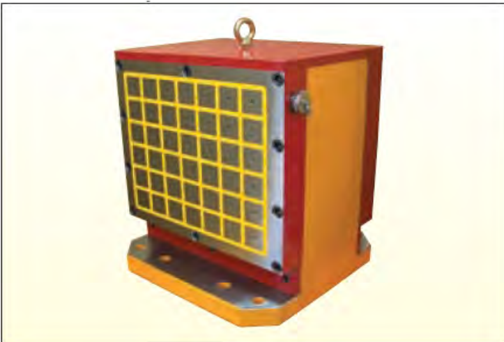
Spodná platňa Indukčného bloku na rýchlu výmenu rôznych obrobkov
